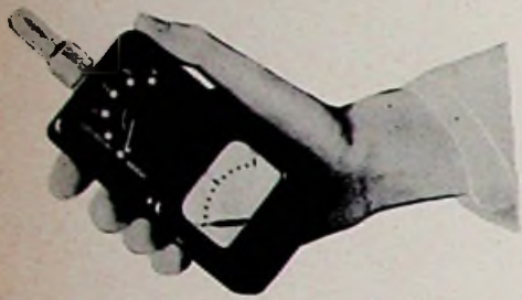
Bild 10. „Wechselspannungsdetektor“ der französischen Fa. Brion, Leroux & Cie., bestehend aus Suchspule, Transistorverstärker und Instrument
