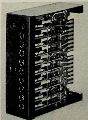
Bild 2. Dezimal-Zählleinheit von Valvo mit Kaltkathodenröhren und gedruckter Schaltung
