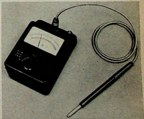
Bild 3. Das handliche Temperaturmeßgerät Thermizet von Siemens & Halske
